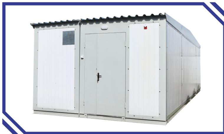
Комплектные трансформаторные подстанции наружной установки, с номинальным напряжением 6(10)/0,4кВ, предназначены для приема, преобразования и распределения электрической энергии трехфазного переменного тока частотой 50 Гц. КТПН комплектуются системой внутреннего освещения для удобства обслуживания отсеков. КТПН изготавливается в холодном исполнении (без утепления) из оцинкованной или крашенной стали.
