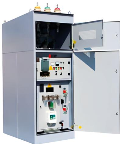
Ячейка высоковольтная серии КРН-4 предназначены для приема и распределения электрической энергии трехфазного переменного тока частотой 50 Гц напряжением 6(10)кВ и используется в распределительных устройствах собственных нужд электростанций, электрических подстанций энергосистем и промышленных предприятий, а также на объектах энергоснабжения ответственных потребителей сельского хозяйства.
